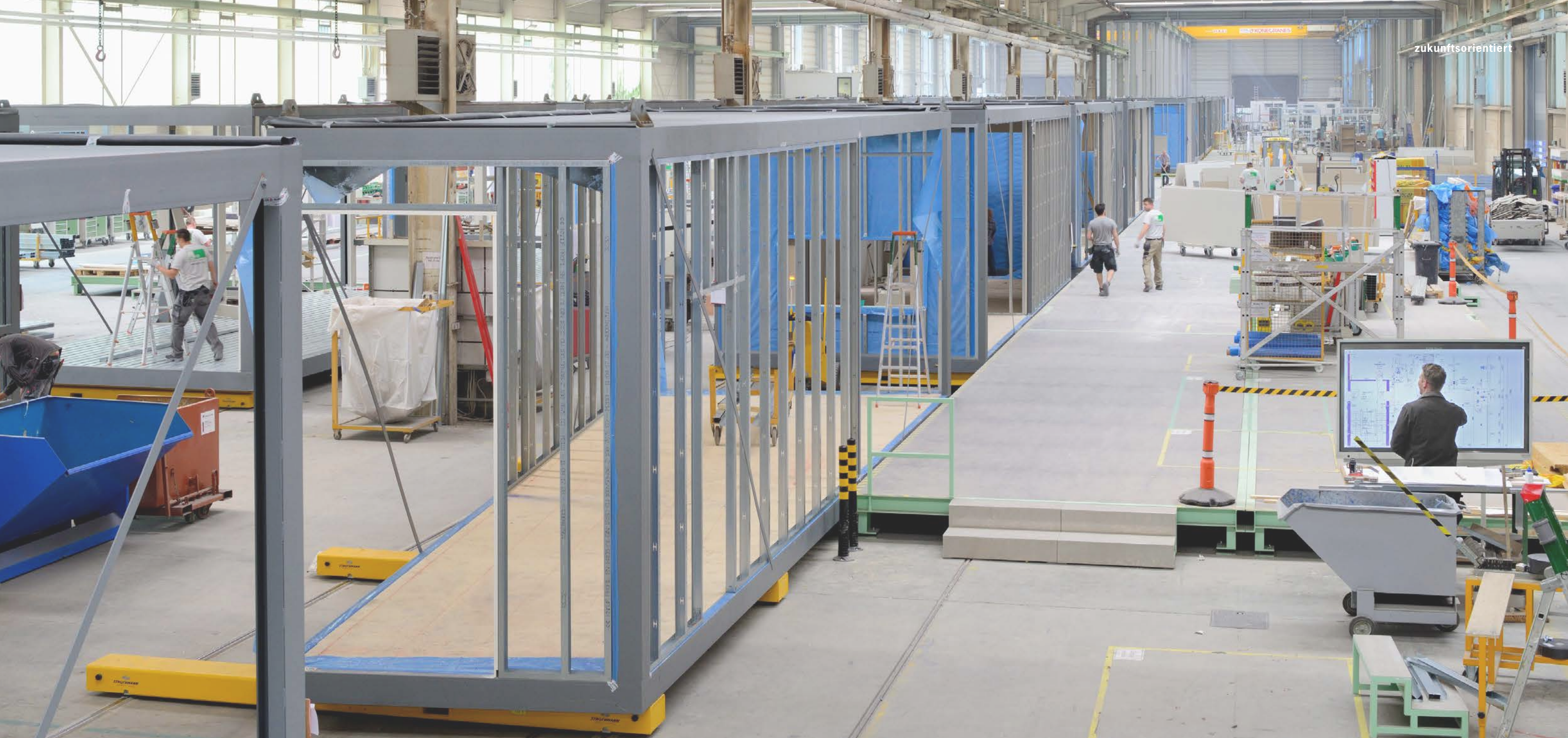
Die serielle Fertigung in der ALHO Raumfabrik
