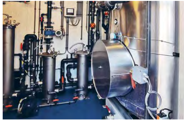
Bioreaktor zur Anzucht der Dehalococcoides-Kulturen vor Ort
